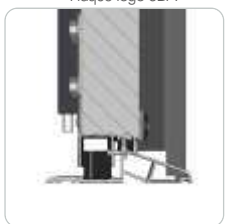
Seuil aluminium 20mm vue coupe basse
