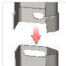
Manchonage du rail
