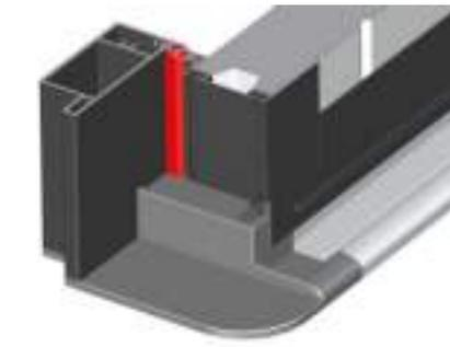
Joint d'étanchéité tubulaire EPDM côté ouverture
